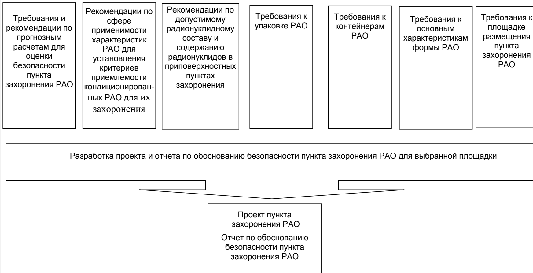
Рис.2. Схема принятия технических решений по проекту пункта захоронения РАО
