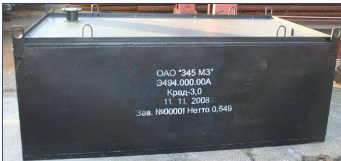
Рис. 3. Контейнер КРАД-3,0 с устройством для омоноличивания ТРО
