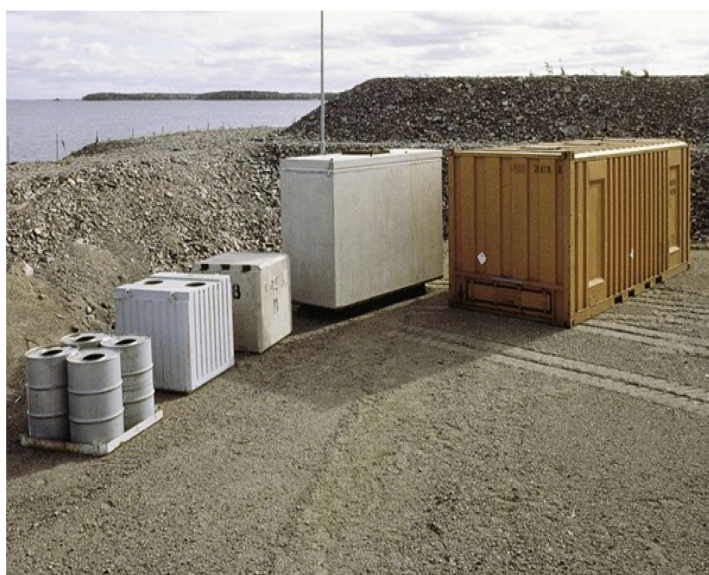
Рис. 4. Контейнеры для РАО, используемые в Швеции
